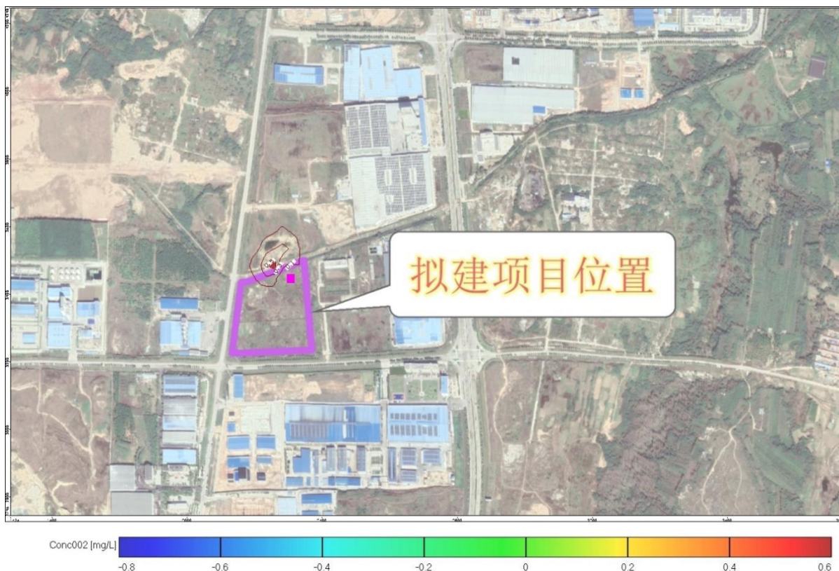
图 7.5-7 (2) 连续泄漏事故 300 天后氨氮污染羽
