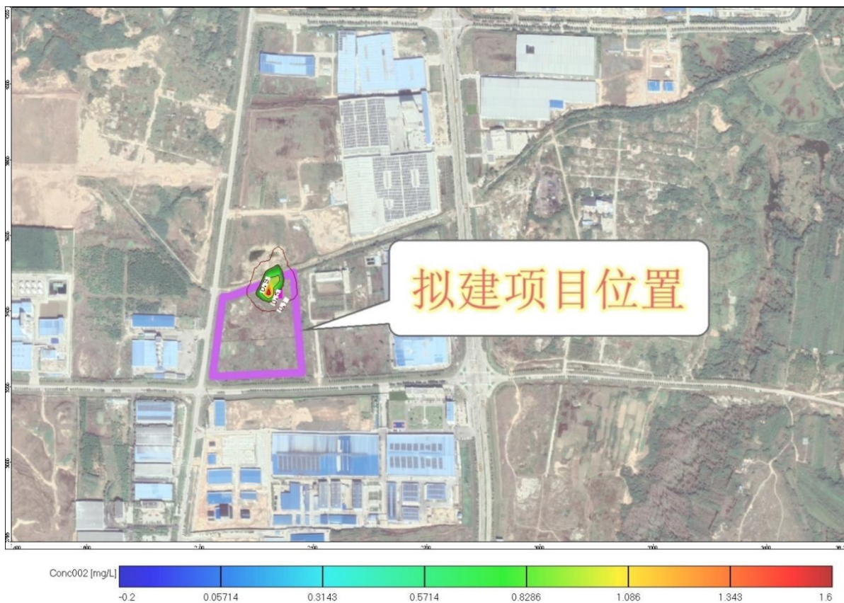
图 7.5-7 (1) 连续泄漏事故 100 天后氨氮污染羽
