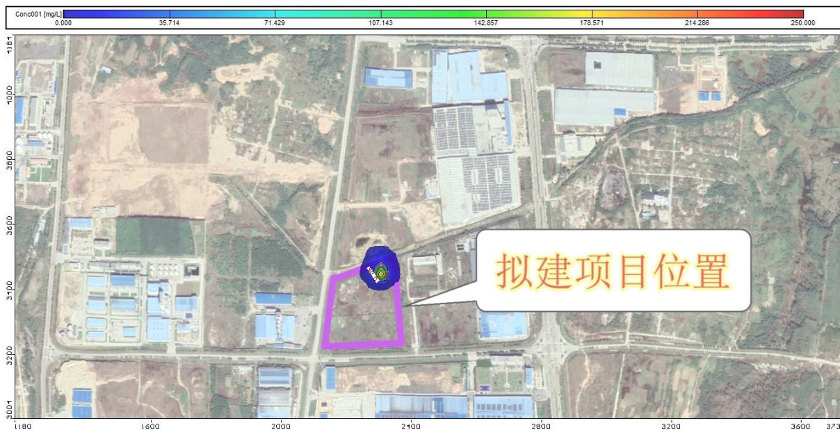
图 7.5-5 (1) 连续泄漏事故 100 天后 COD 污染羽
