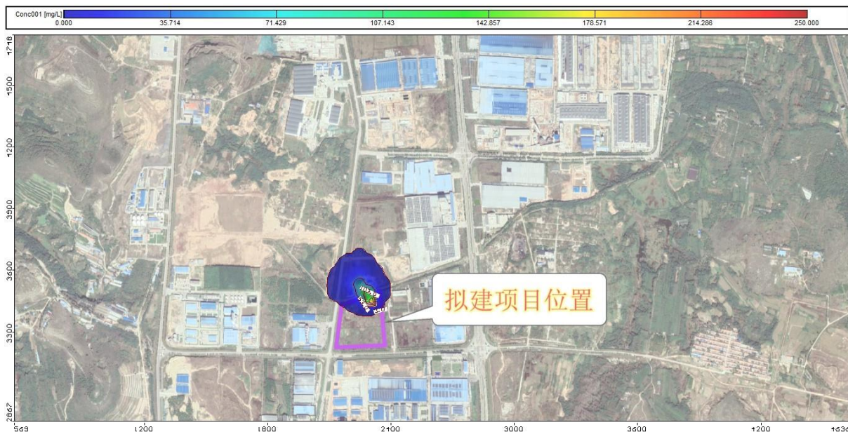
图 7.5-5 (2) 连续泄漏事故 1000 天后 COD 污染羽
